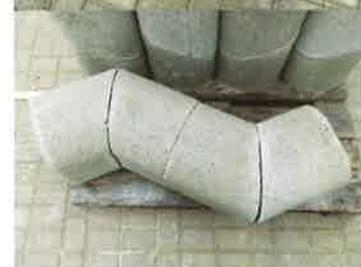
1 Stk. Gabelstein, zum Anlegen eines Rundkessels mit Paralleleingang sowie für alle anderen Abzweige geeignet. Der Gabelstein hat eine extrem spitzwinklige „Umkehre“ und eine massive Querschnittsreduzierung. Ein Rundlaufen ist fast unmöglich.
